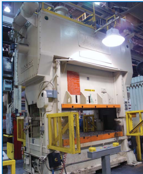
MINSTER S2-200-84-48 STRAIGHT SIDE DBL CRANK PRESS
