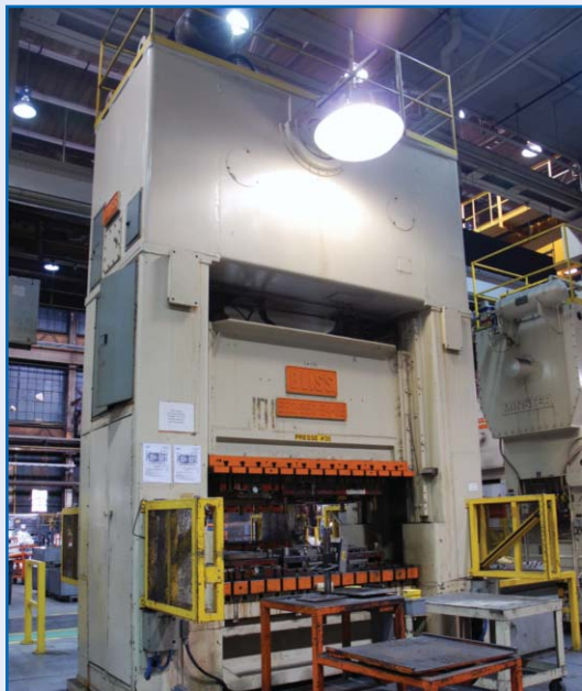
BLISS SE2-350-84-36 STRAIGHT SIDE DBL CRANK PRESS
