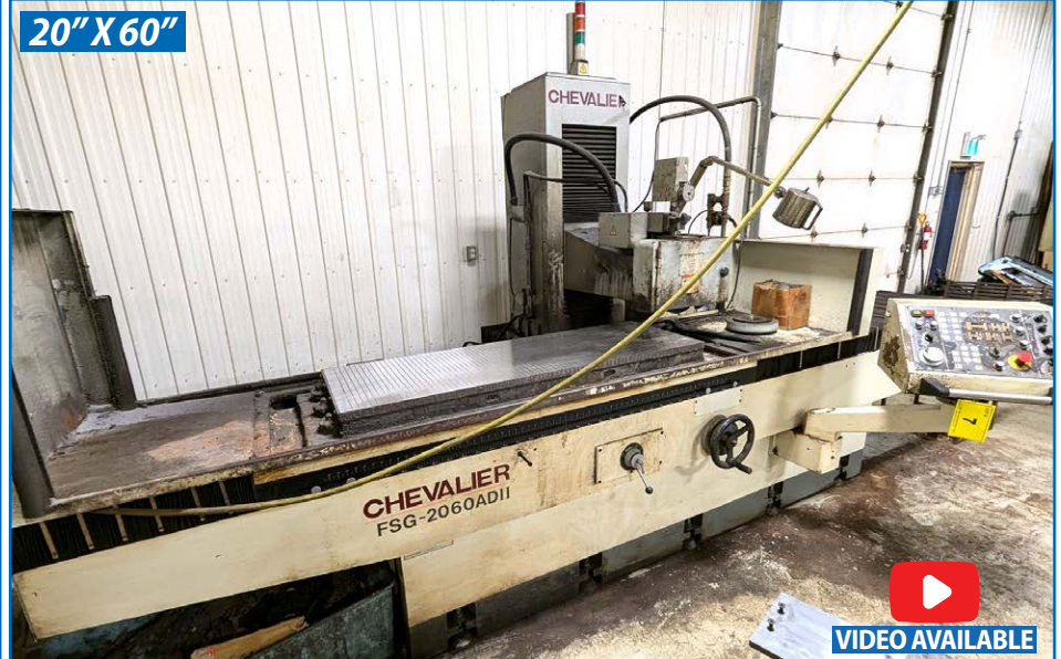
CHEVALIER FSG-2060ADII SURFACE GRINDER
