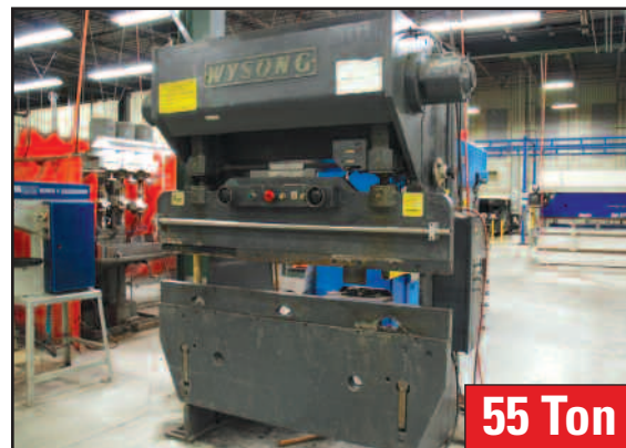
WYSONG PRESS BRAKE MODEL H-55-4
